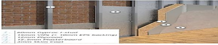
شكل (2) العزل الحراري الداخلي للحوائط ب ألواح VIPs
