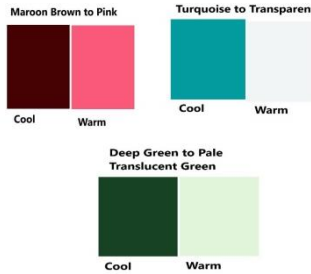
شكل رقم (١٢) يوضح التغير اللوني لدهانات النانو عن تغير درجة الحرارة
