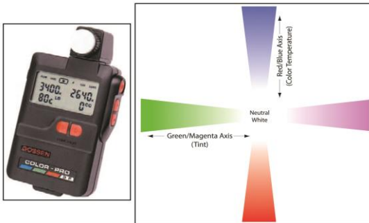
شكل (٢): (إلى اليسار) جهاز قياس اللون الرقمي (The Gossen Color Pro Color Meter). (إلى اليمين) محوري القياس اللوني التي تعمل عليهما أجهزة قياس اللون (Color Meters).
