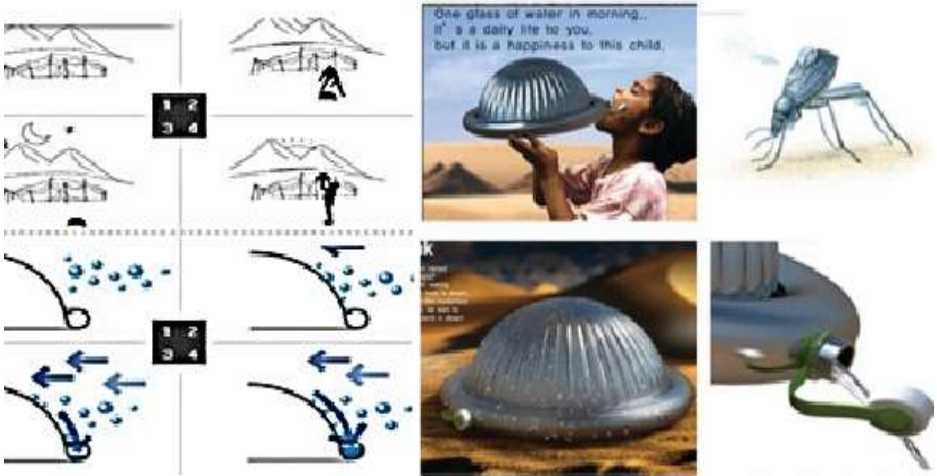
صورة (14) فكرة بسيطة للحصول علي مياه عذبة بطريقة ذاتيه م عن طريق تكثيف مياه الندي في الصباح والاحتفاظ بها داخل قارورة معدنية.
