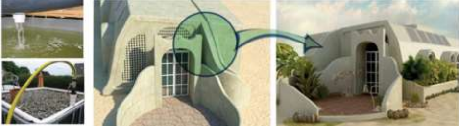
صورة (13) النموذج المقترح يوضح ميل السقف إلي الخلف وحصاد مياه الأمطار في مجري موصل إلي خزان المياه الشرب حيث يتم مرور المياه علي سبع مراحل للفلتره مرورا بالزلط - الرمل - القماش - الفحم - الرمل ثم الزلط. https://balexu.journals.ekb.eg/article_198524.html
