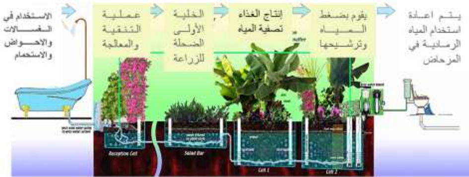
شكل توضيحي (7) لمراحل تنقية المياه الرمادية والسوداء وإعادة استخدامها في الإحتياجات الأساسية
