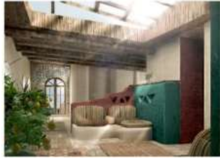
صورة (17) تصميم الوحدة المقترحة وفتحات في السقف لغمر المكان بالضوء الطبيعي كما يعمل على خروج الهواء الساخن من أعلي.
