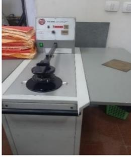
الشكل (٦) يوضح جهاز نفاذية الهواء
