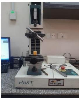
شكل (٥) يوضح الجهاز المستخدم لقياس ثبات الوبرة
