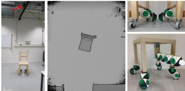
صورة (٤) توضح دمج تقنيات الروبوتات ذاتية التشكيل مع الأثاث التقليدي.
