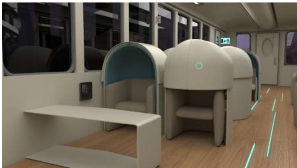
صورة رقم (9) يوضح تصميم مقعد القطار المصمم تبعاً لاحتياجات مرضى التوحد وهو في الوضع المغلق (الأكثر خصوصية)، وفي الوضع المفتوح (الاستخدام العادي).
