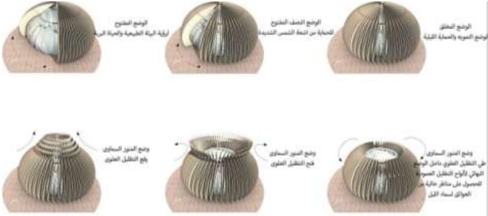
شكل (11) يوضح الواح التظليل الاشعاعي المفصلية التي تخلق شبكة كثيفة تحمي المقصورة , ويظهر ستة خيارات تصميمية لتحقيق جودة الهواء والتظليل الداخلى
