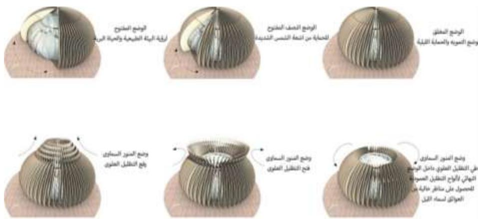
شكل (11) يوضح الواح التظليل الشعاعي المفصلي التي تخلق شبكة كثيفة تحمى المقصورة ، ويظهر ستة خيارات تصميمية لتحقيق جودة الهواء والتظليل الداخلي
